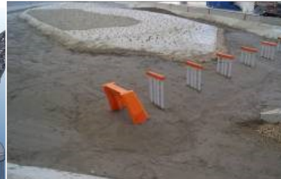
MODELLO FISICO DI UN TRATTO DI Fiume PO PER IL NUOVO PONTE AUTOSTRADALE DI CASTELVESTRO PIACENTINO
