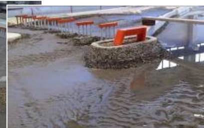
MODELLO FISICO DI UN TRATTO DI Fiume PO PER IL NUOVO PONTE AUTOSTRADALE DI CASTELVESTRO PIACENTINO
